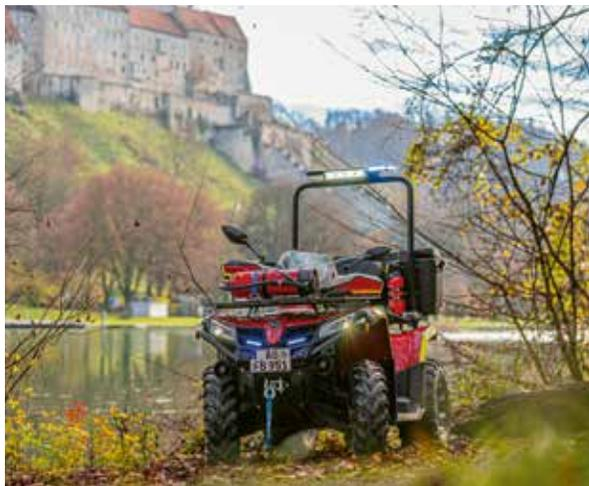
schaften, welche auf dem Sonderfahrzeug verlastet sind. Eine Frontseilwinde mit einer Zugkraft von **1.130 kg** kann nicht nur Lasten, sondern auch das Fahrzeug selbst in extremem Gelände, bewegen. Regelmäßige Ausbildungseinheiten auf diesem Sonderfahrzeug sorgen für einen sicheren und routinieren Umgang der ATV-Besatzung im Einsatzfall. Egal ob bei Vermissten-suchen, Wasserrettungseinsätzen,
