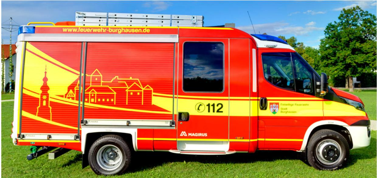
Bei Unwetterlagen und technischen Hilfeleistungen kann das Fahrzeug mit zahlreichem Werkzeug, umfangreichem Schanz- und Räummaterial, sowie einer leistungsfähigen Schmutzwasserpumpe als eigenständige Einheit eingesetzt werden. Ein pneumatisch ausfahrbarer Lichtmast mit LED-Technik ermöglicht sicheres Arbeiten auch bei Dunkelheit. Für die Personenrettung stehen unter anderem ein Gerätesatz Absturzsicherung, ein Rettungsbrett und eine Schleifkorbtrage zur Verfügung.
