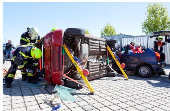
Dreieck-Stabilisierungs-Systems gesichert. Diese Maßnahmen dienen dem Schutz von Patienten und Einsatzkräften, da weitere unkontrollierte Bewegungen der Unfallfahrzeuge ausgeschlossen werden und eine solide Grundlage für den Einsatz von hydraulischem Rettungsgerät geschaffen wird.
